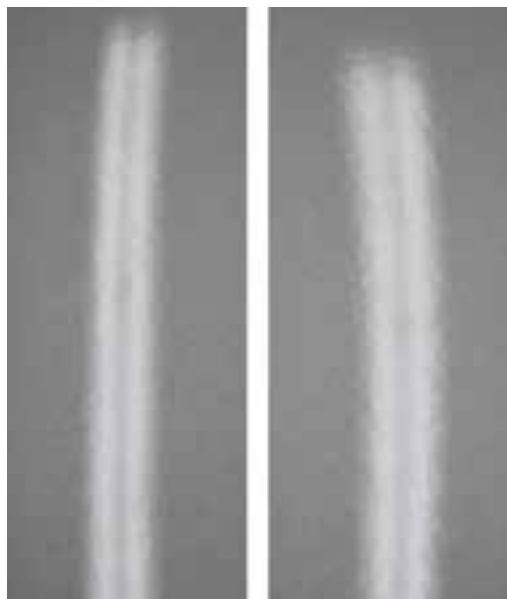
Quest'immagine mostra due pannelli. Il campione sulla sinistra è rivestito con Ultragal®. Si noti il riflesso della luce fluorescente. L'ondulazione del pannello sulla destra (trattato con Extragal®) è evidenziata dal riflesso distorto.
