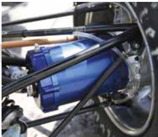
Ogni ruota è alimentata da un motore elettrico indipendente realizzato con iCARE® Save.
